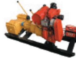
Tıynet Çamur Pompaları
